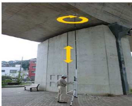
写真-1【橋梁点検ロボットカメラ】
